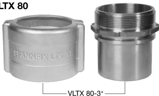
Schlaucheinbindung **nur** mit **Spezial-Schlaucharmatur VLTX 80-3"** (SLTX 80 Spannklemme und VST 80-3" Vaterstutzen aus Messing oder Edelstahl). Keine anderen Armaturen verwenden.
