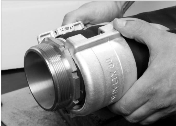
SPANNFIX anlegen wie gezeigt. Für LTX 80 nur Spezial-Spannklemme SLTX 80 verwenden.
