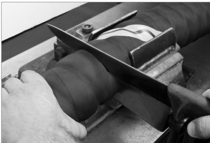
Schlauch **gerade** einspannen. Mit scharfem Schlauchmesser **gerade** ablängen.
