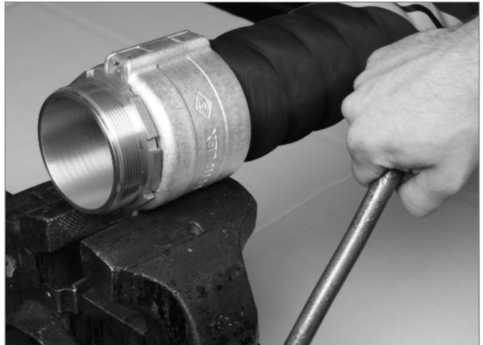
SPANNFIX mit Hilfe des Schraubstocks zusammendrücken, bis sie vollständig geschlossen ist.
