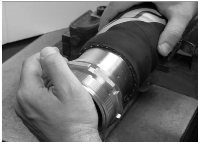
Schlauchstutzen in den Schlauch einsetzen.
